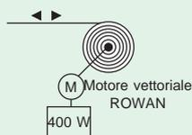
Questa funzione si utilizza solo nel caso di avvolgimento/svolgimento di una bobina motorizzata in asse e si voglia **imporre** una velocità periferica costante al variare del diametro della bobina.
