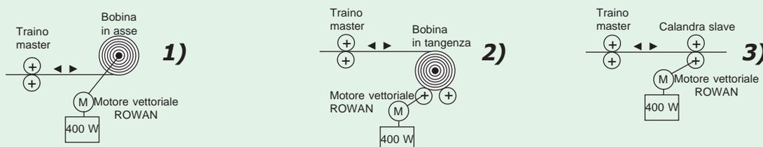
Questa funzione si utilizza in tutti casi sia necessario mantenere un **tiro** sul materiale, tra un traino master, una bobina da avvolgere/svolgere o una calandra slave, senza l'ausilio di celle di carico o altri sistemi di retroazione del tiro.
