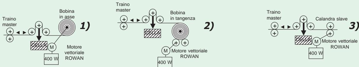
Questa funzione si utilizza in tutti casi sia necessario mantenere un  **tiro**  sul materiale, tra un traino master, una bobina da avvolgere/svolgere o una calandra slave, con retroazione da celle di carico o altri sistemi di retroazione.
