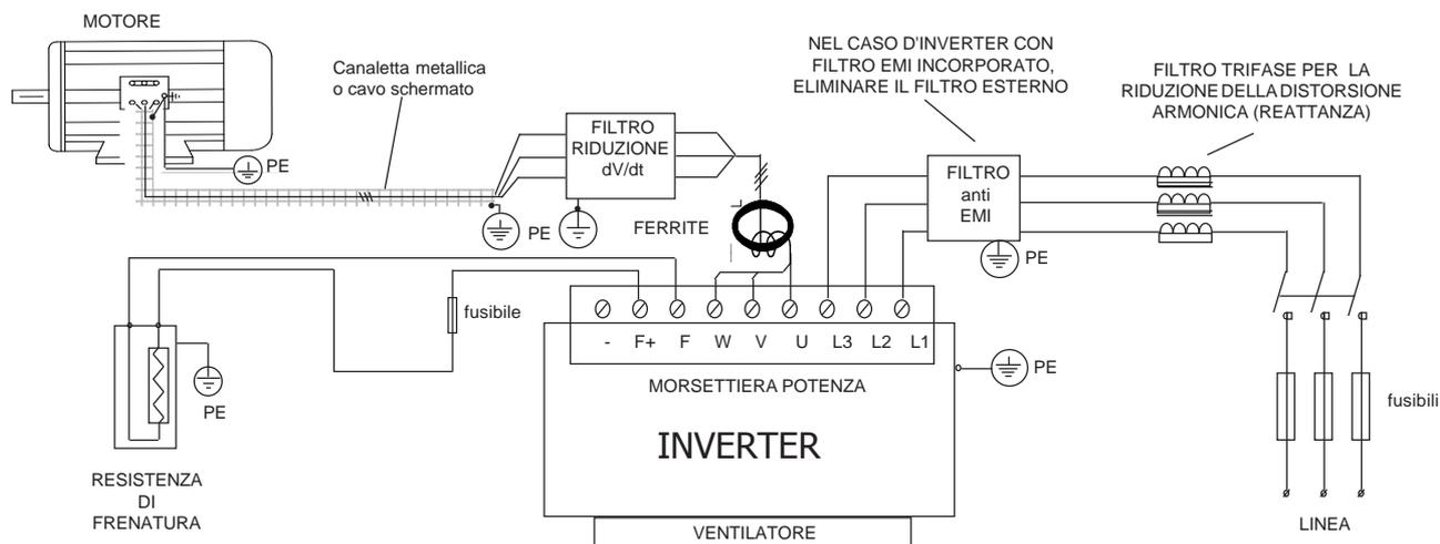
Tale filtro, oltre a ridurre la distorsione armonica, riduce la corrente efficace assorbita dall'inverter, consente una maggiore protezione dell'azionamento da eventuali buchi o picchi di tensione provenienti dalla rete; in particolare riduce i picchi di corrente che attraversano i condensatori interni all'inverter allungandone ulteriormente la vita.
