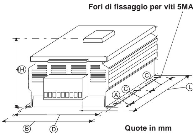
Fori di fissaggio per viti 5MA
