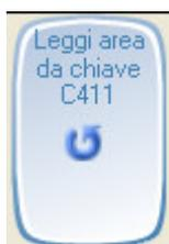
Con il comando "**Leggi area da chiave C411**" si effettua l'acquisizione dati da un'area di memoria prescelta tramite il *selettore area di memoria*. Si ricorda infatti che è possibile leggere il contenuto di una sola area per volta. Prima di avviare l'operazione accertarsi che l'interfaccia *C426S* sia collegata al PC e che una chiave EEPROM *C411S* sia inserita nell'apposito connettore.
