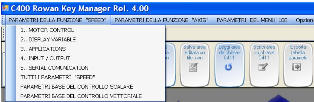
Tramite questa barra sono disponibili i nomi delle varie tabelle che contengono parametri del prodotto selezionato. Ogni tipo di prodotto dispone di determinati parametri e menù, quindi anche il numero e il nome delle tabelle potrà cambiare a seconda dell'impostazione effettuata nel **“selettore prodotti”**.
