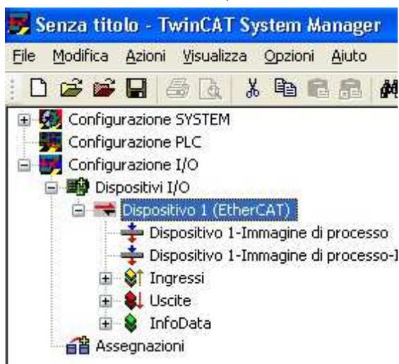
3) Una volta acquisito automaticamente il dispositivo, rispondere SI alla richiesta di eseguire una ricerca automatica del modulo Ethercat
