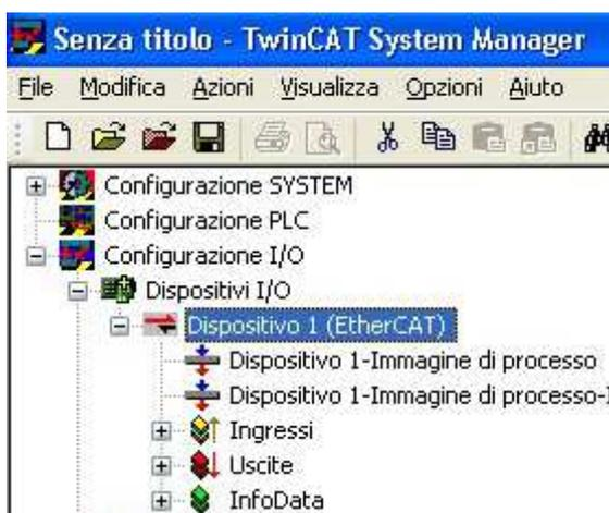
4) Aggiungere il modulo EtherCAT dell'inverter 400 tramite il comando **"Aggiungi box"**
